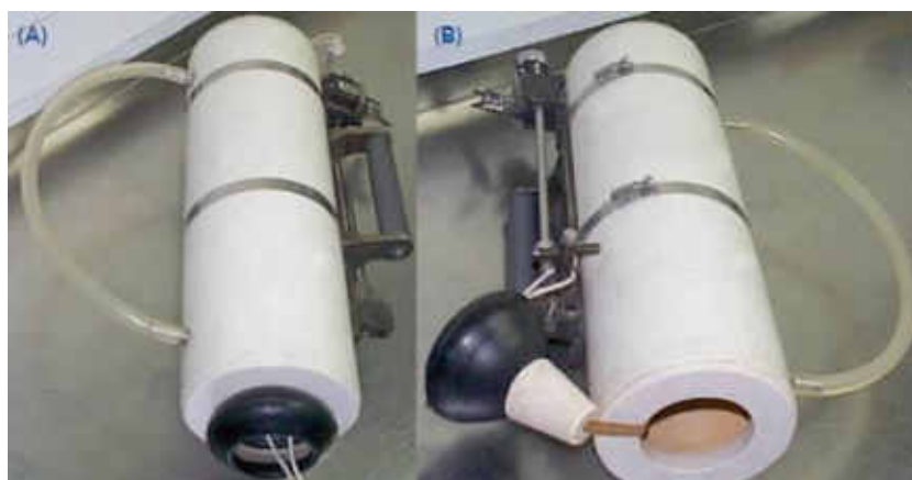
Figura 8.16: Garrafa De Van Dorn De Fluxo Vertical: (A) Garrafa Desmontada; (B) Garrafa Montada
