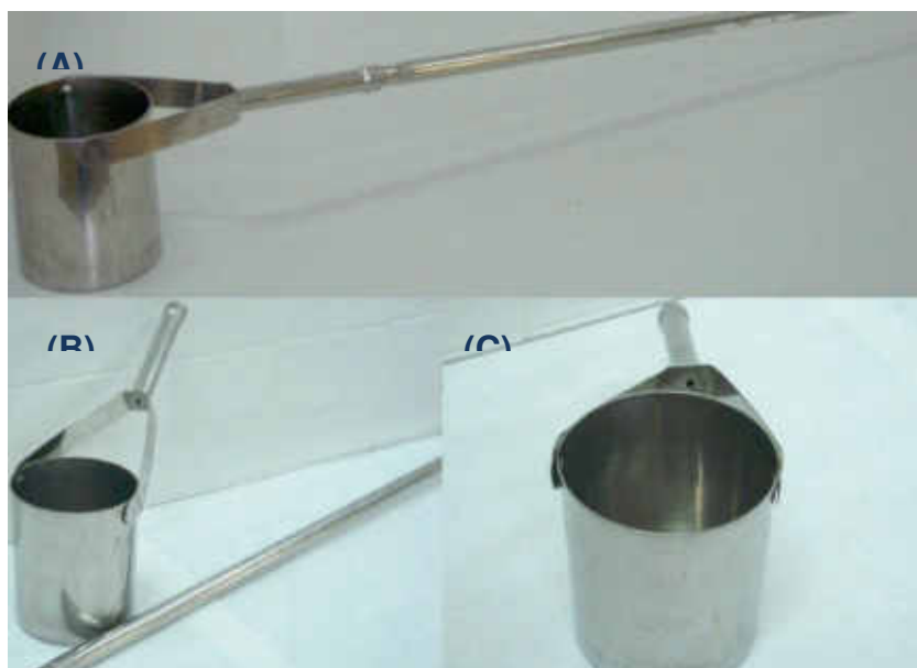
Figura 8.15: Coletor Com Braço Retrátil: (A) Vista Lateral Do Equipamento Montado; (B) Vista Do Balde E Do Braço Retrátil Desmontado; (C) Vista Superior Do Balde Coletor
