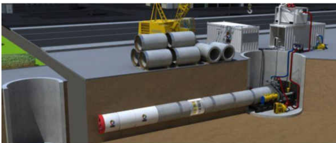
Figura 7.7: Esquema de Serviço com Tuneladora
