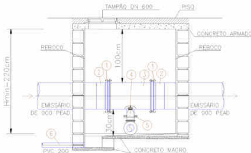
Figura 7.11: Caixa de Drenagem da Tubulação
