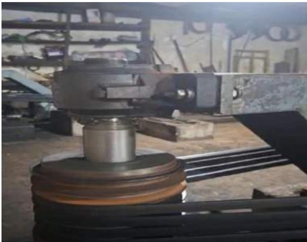
Foto 06: Eixo turbina, com sistema de correias e polias
