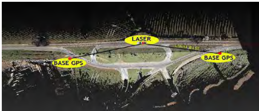
Esquema do Levantamento com o Pegasus:TWO ULTIMATE
