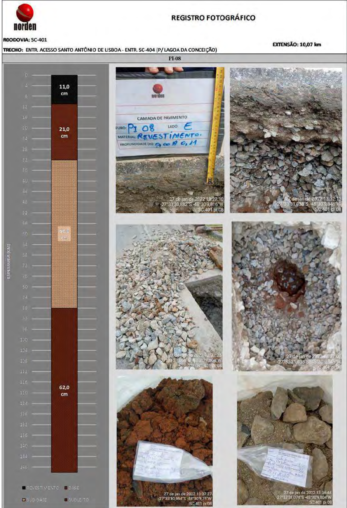
Relatório Fotográfico das amostras dos Poços de Inspeção (8)
