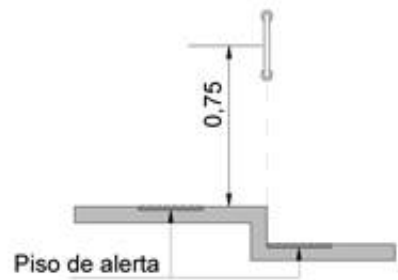
b) Barra de apoio vertical
