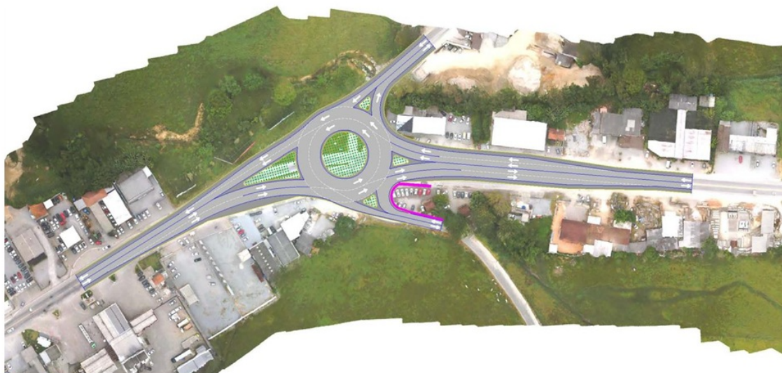
Figura 3.15 – Interseção Nº 1 - Km 23+640 – Alternativa 3.
