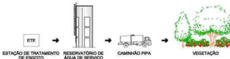
Figura 3.171: Reúso Não Potável – Irrigação Paisagística com Transporte de Caminhão Pipa. Fonte: Engeplus Engenharia e Consultoria Ltda
