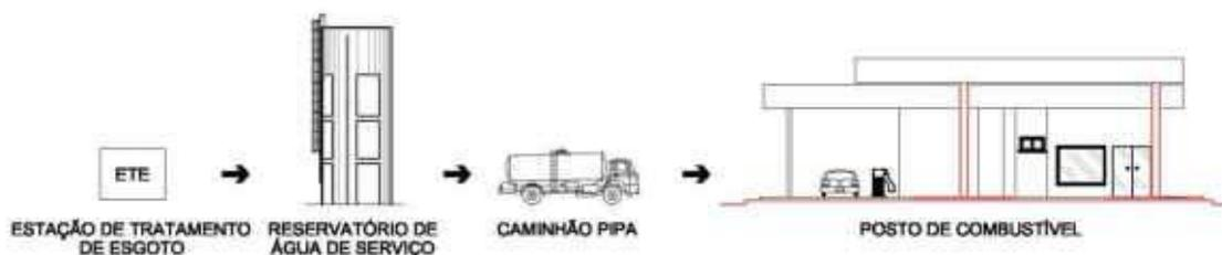
Figura 3.172: Reúso Não Potável – Lavagem de Veículos com Transporte de Caminhão Pipa. Fonte: Engeplus Engenharia e Consultoria Ltda
