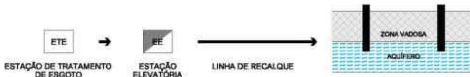
Figura 3.177: Reúso Não Potável – Recarga de Aquífero – Injeção Direta. Fonte: Engeplus Engenharia e Consultoria Ltda
