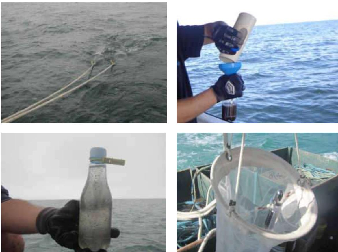
Figura 3.92: A) Rede de zoo/ictioplâncton Realizando coleta Subsuperficial Quali/Quantitativa. B) Transferência da Amostra do Copo Coletor da Rede Para Garrafa. C) Exemplo de Amostra de Zoo/Ictioplâncton. D) Detalhe do Fluxômetro Acoplado a Boca da Rede
