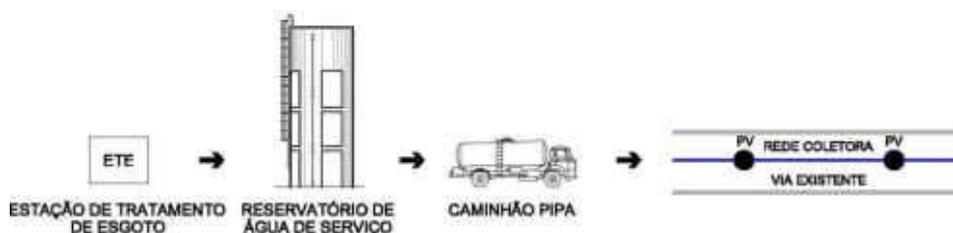
Figura 3.174: Reúso Não Potável – Desobstrução de Rede de Coletora de Esgoto com Transporte de Caminhão Pipa. Fonte: Engeplus Engenharia e Consultoria Ltda
