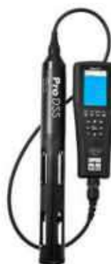
Figura 3.57: Sonda YSI, Modelo Pro DSS, Utilizada no Levantamento dos Parâmetros Físico-Químicos da Água
