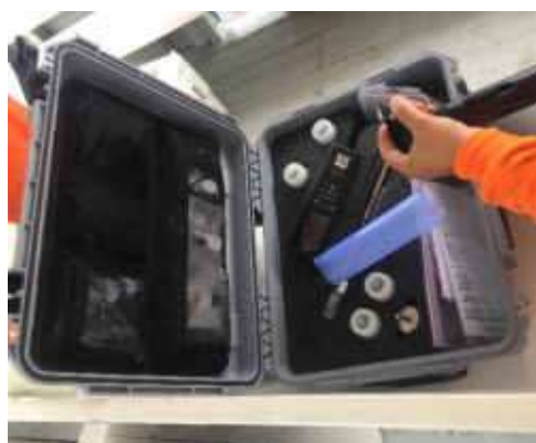
Figura 3.57: Sonda YSI, Modelo Pro DSS, Utilizada no Levantamento dos Parâmetros Físico-Químicos da Água
