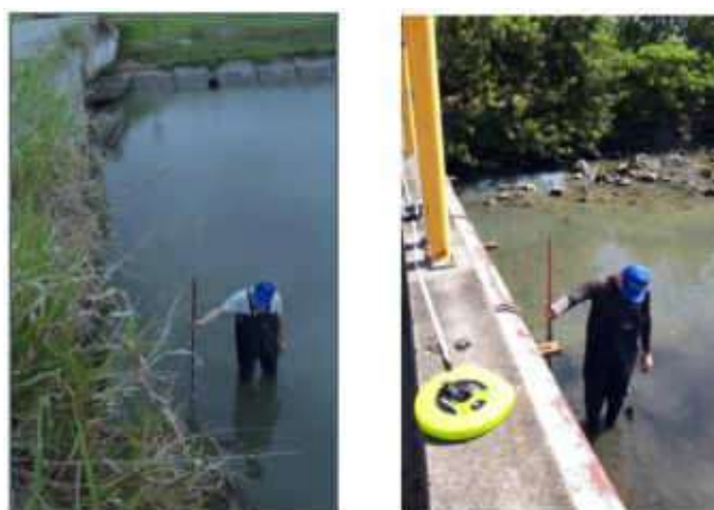
Figura 3.16: Medição das Seções nos Canais Monitorados
