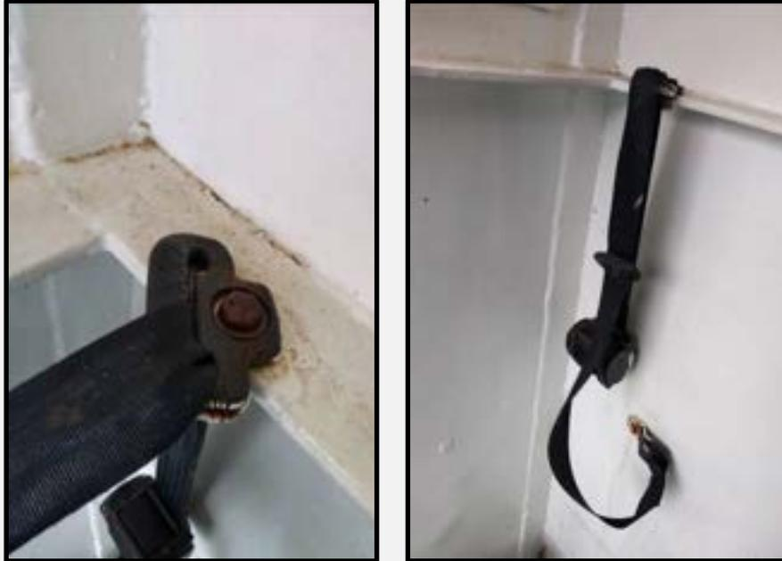
**Figura 39:** Cintos de segurança para cadeirantes com pontos de fixação enferrujados.
