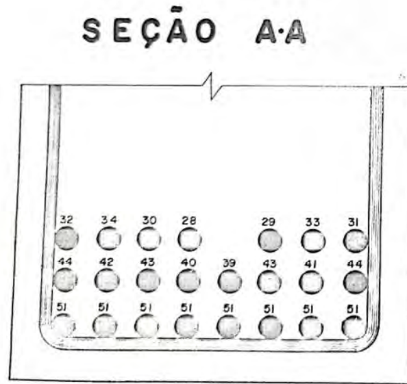
Figura 7 - Seção da viga longarina conforme Projeto Executivo
