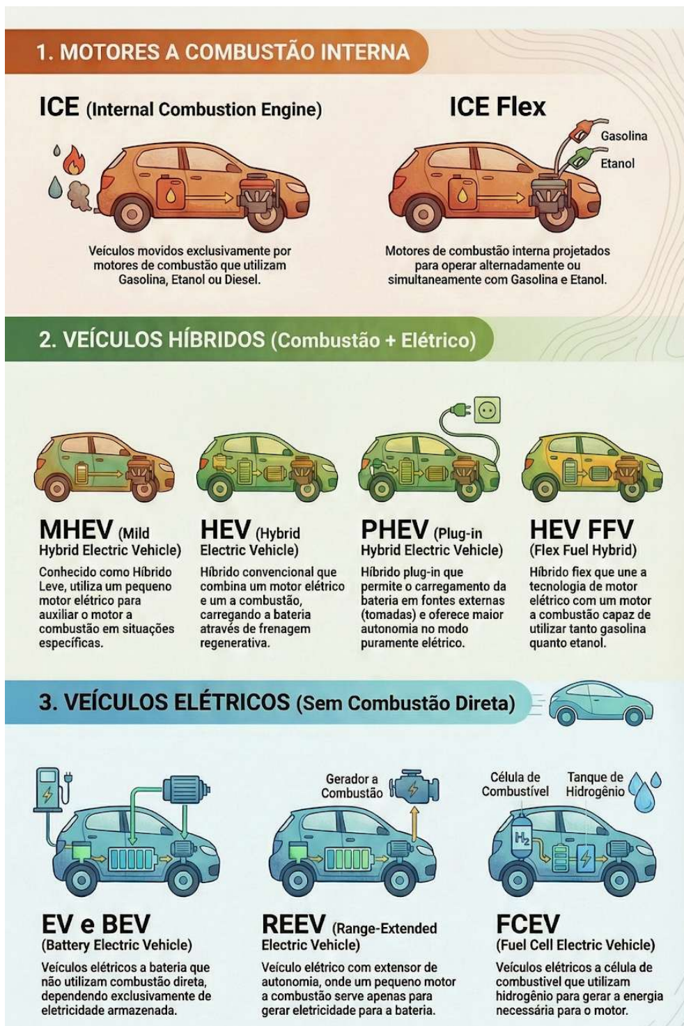
Figura 1: Veículos no mercado brasileiro em 2026. Combustão interna: Gasolina ou Etanol ou Diesel ( Internal Combustion Engine - ICE ), Flex - Gasolina e Etanol ( ICE Flex ); Híbridos , nos quais existe um motor elétrico e outro a combustão: Híbrido leve ( Mild Hybrid Electric Vehicle - MHEV ), Híbrido convencional ( Hybrid Electric Vehicle - HEV ); Híbrido plug-in ( Plug-in Hybrid Electric Vehicle - PHEV ), Híbrido flex ( Flex Fuel Hybrid - HEV Flex ); Elétricos , nos quais não há combustão direta: Elétrico ( Electric Vehicle - EV ), Elétrico a bateria ( Battery Electric Vehicle - BEV ), Elétrico com extensor ( Range-Extended EV - REEV ), e Hidrogênio ( Fuel Cell Electric Vehicle - FCEV ). Elaborada com o aplicativo NotebookLM, disponível em: https://notebooklm.google.com/
