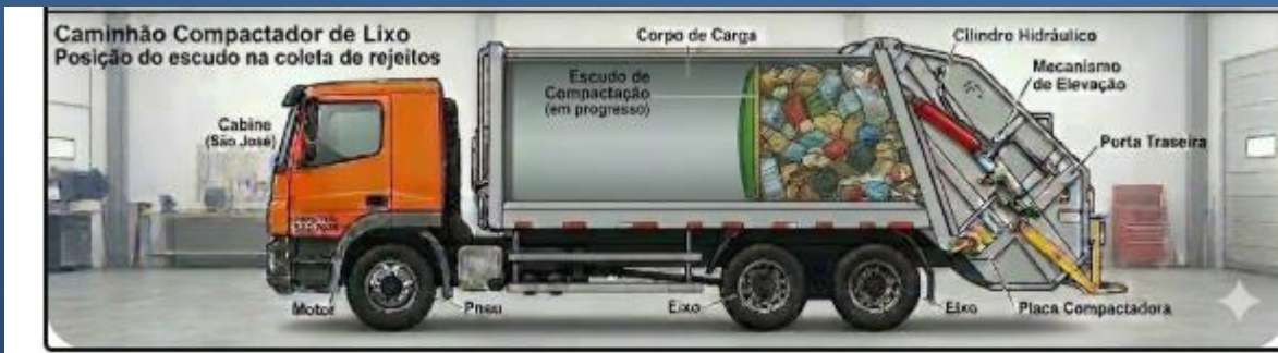
Figura 1 - Sistema de compactação da carga na coleta de RSD, com o cilindro de compactação se deslocando junto com a massa de resíduos.
