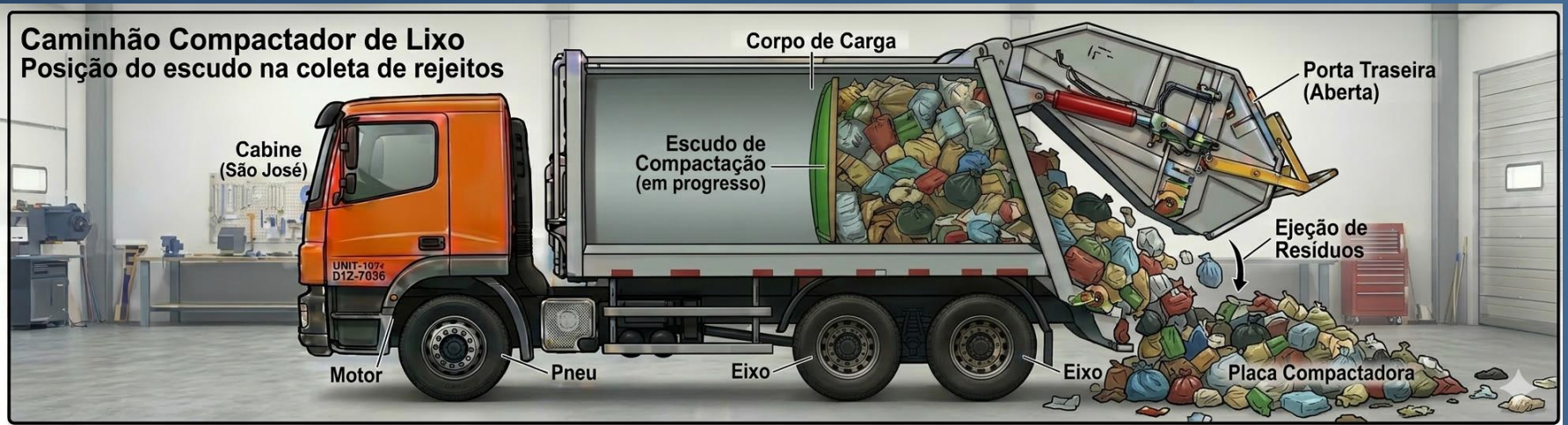
Figura 3 - Sistema de funcionamento do caminhão compactador para descarga mecânica dos resíduos
