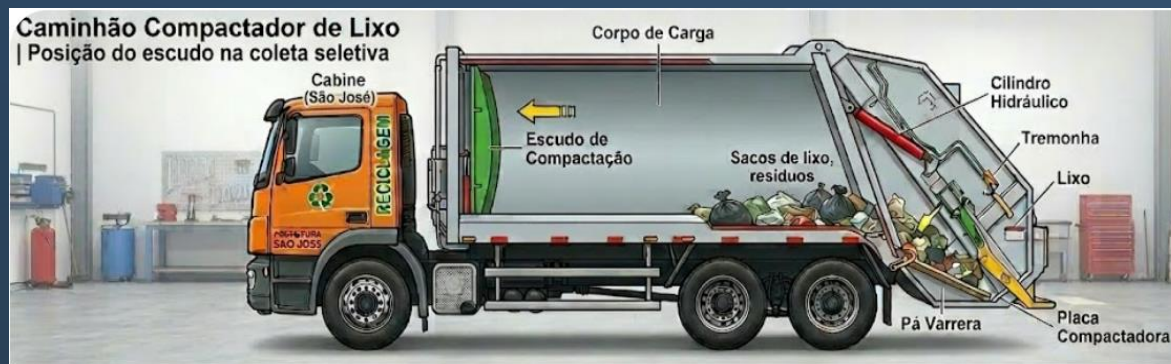
Figura 2 - Sistema de funcionamento do caminhão compactador na coleta seletiva, com o escudo de compactação deslocado para o fundo da caçamba..
