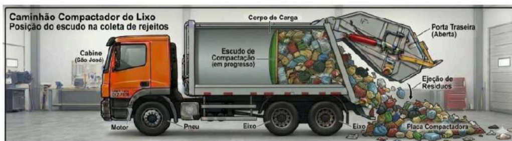
Figura 5 - Sistema de funcionamento do caminhão compactador para descarga mecânica dos resíduos. Fonte: imagem gerada pelo autor com apoio do IA Gemini.
