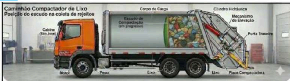
Figura 3 - Sistema de compactação da carga na coleta de resíduos indiferenciados, com o cilindro de compactação se deslocando junto com a massa de resíduos. Fonte: imagem gerada pelo autor com apoio do IA Gemini.
