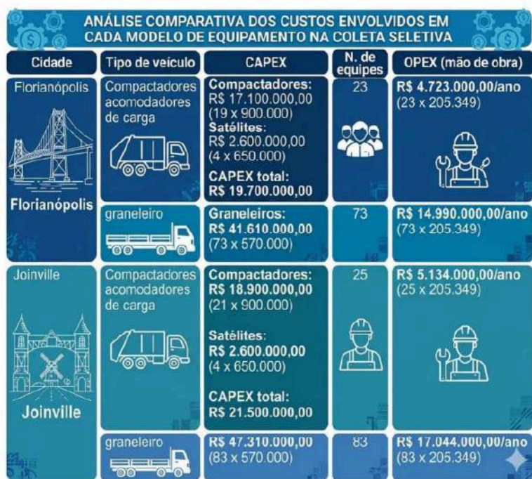
Figura 8 – Análise comparativa dos custos envolvidos na coleta seletiva com uso de caminhões graneleiros e compactadores acomodadores de carga para os municípios de Florianópolis e Joinville. Fonte: autores.
