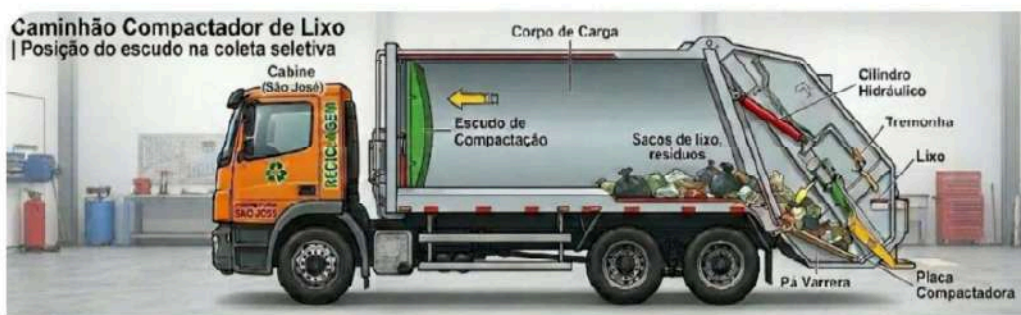
Figura 4 - Sistema de funcionamento do caminhão compactador acomodador de carga na coleta seletiva, com o escudo de compactação deslocado para o fundo da caçamba. Fonte: imagem gerada pelo autor com apoio do IA Gemini.
