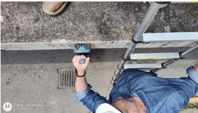
Fotografia 8 – Ensaio de Pacometria
