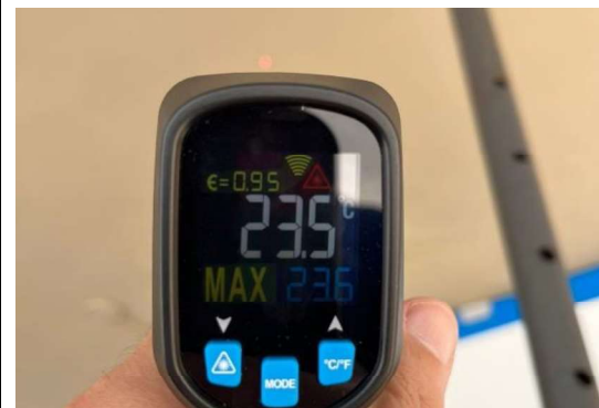
Fotografia 36 – Leitura do Termômetro na face inferior
