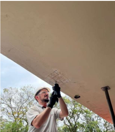
Fotografia 12 – Ensaio de esclerometria
