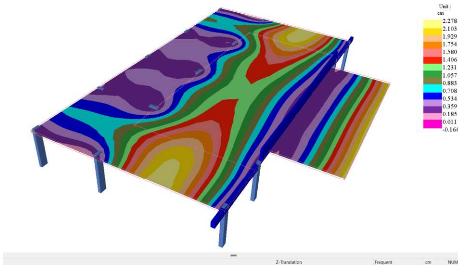
Figura 17 – Deformação vertical para perdas de 60% de \sigma_{pi} .
