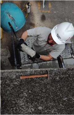
Fotografia 28 – Corpo de prova para ensaio de resistência do concreto.
