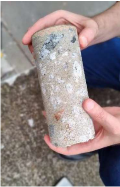
Fotografia 10 – Corpo de prova para ensaio de resistência do concreto.
