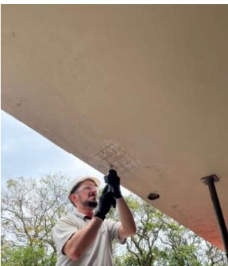
Fotografia 30 – Ensaio de esclerometria
