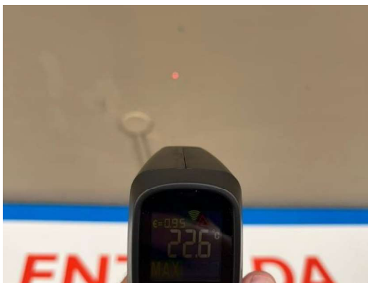
Fotografia 35 – Leitura do Termômetro na face inferior
